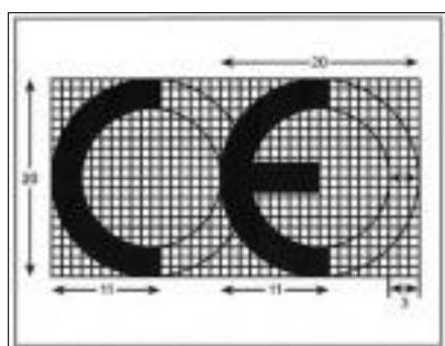
In caso di ridimensionamento della marcatura CE, devono essere rispettate le proporzioni indicate nel disegno di cui all'allegato II del Regolamento 765/2008. In mancanza di disposizioni legislative specifiche che impongano dimensioni precise, la marcatura ha un'altezza minima di 5 mm.
